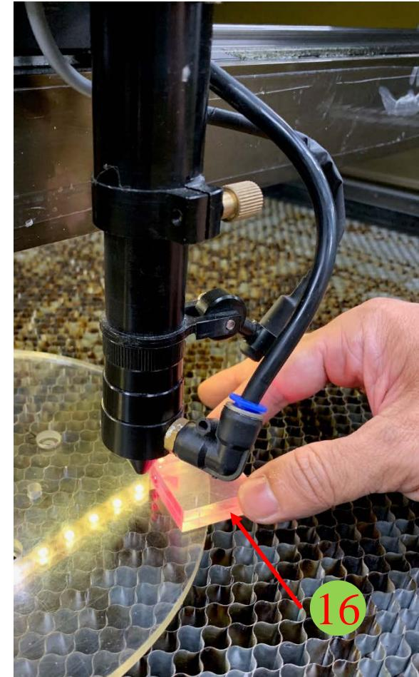
14. 鬆開氣嘴螺絲 → 15. 將9.3mm對焦塊放置在被切割材料上方，氣嘴往下抵住對焦塊
